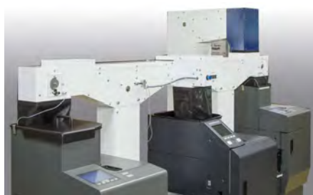
NGZ 208 VB3 un'estensione del sistema di sollevamento per l'alimentazione in continuo di tre avvolgitrici Laurel.
